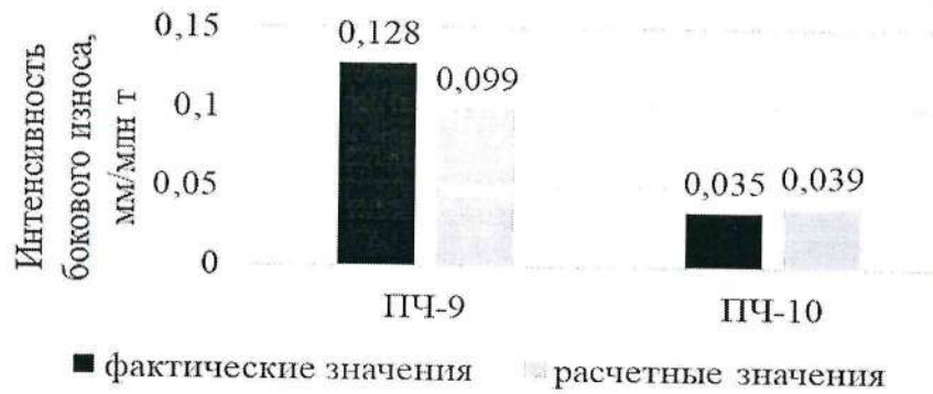
Рисунок 10 – Разница между фактической и теоретической величиной интенсивности бокового износа рельсов
