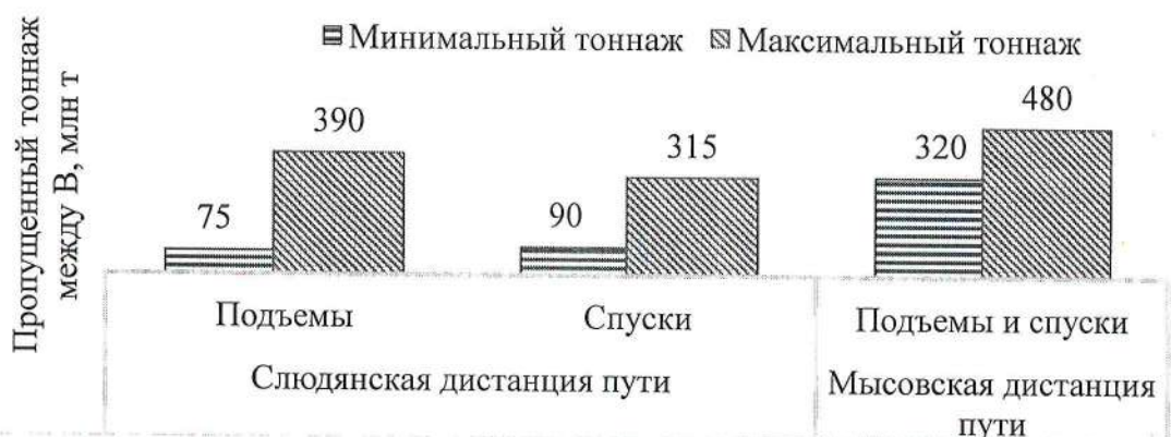
Рисунок 9 – Пропущенный тоннаж в период между выправками пути (ППВ), млн т в 2017-2019 гг, 2 путь
